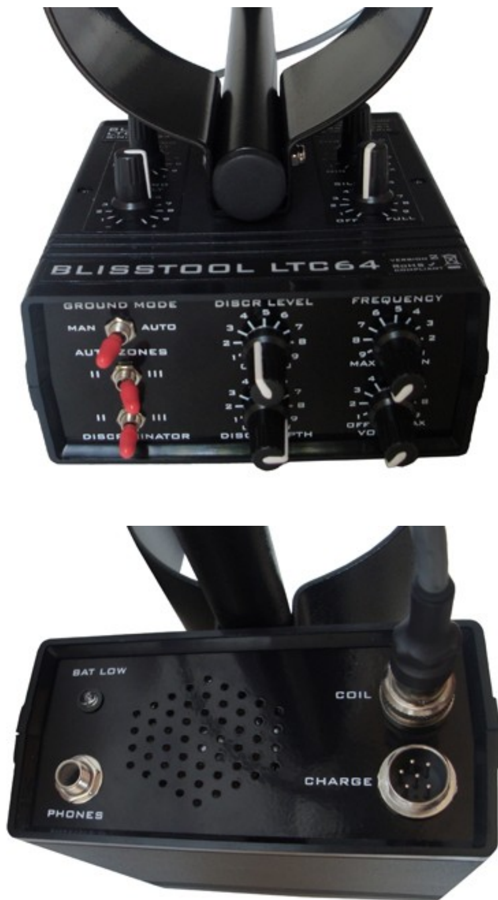
Фиг.3 / Органи за настройка, индикация и обслужване на BLISSTOOL LTC64
