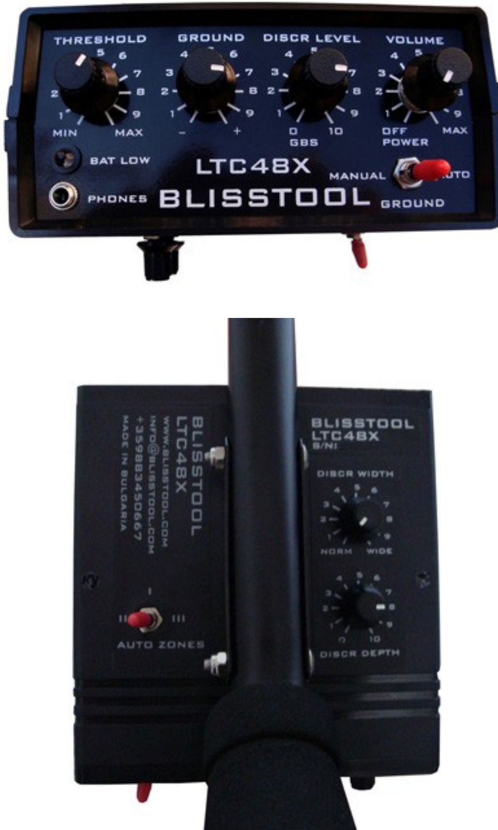
Фиг.3 / Органи за управление, настройка и индикация на BLISSTOOL LTC48X
