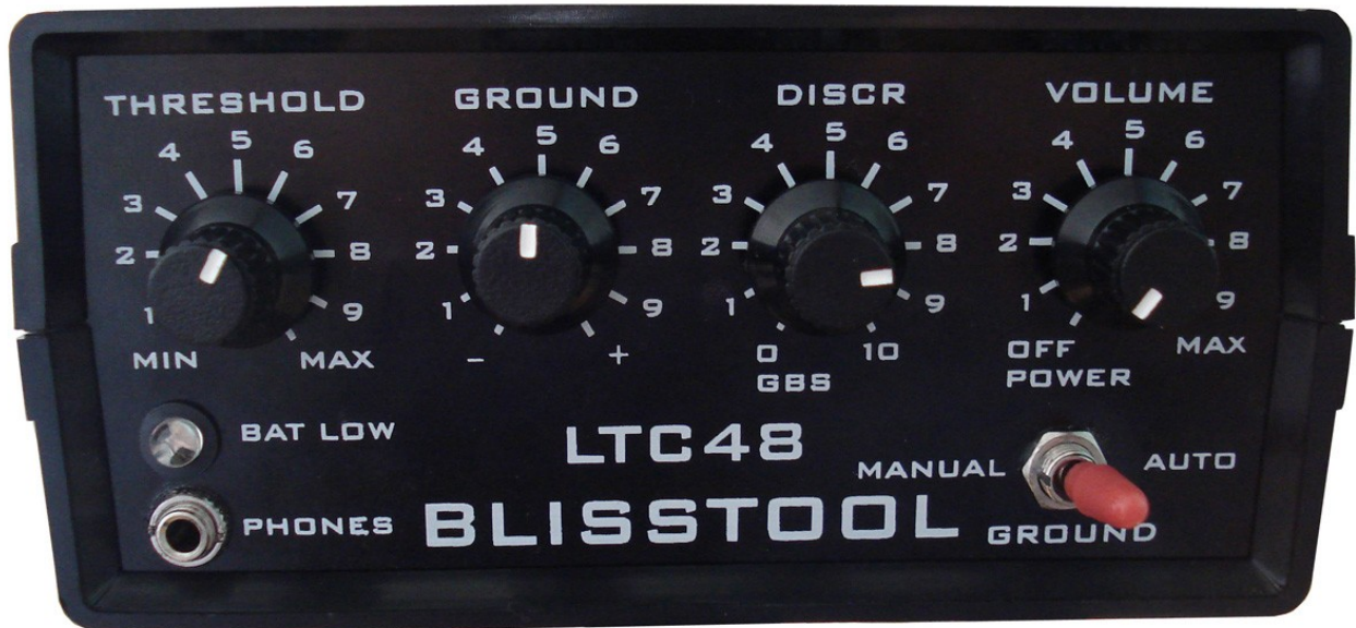
Фиг.3 / Органи за управление, настройка и индикация на BLISSTOOL LTC48
