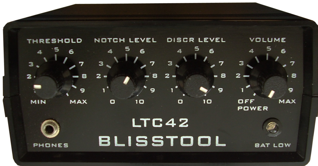
Фиг.3 / Органи за управление, настройка и индикация на BLISSTOOL LTC42
